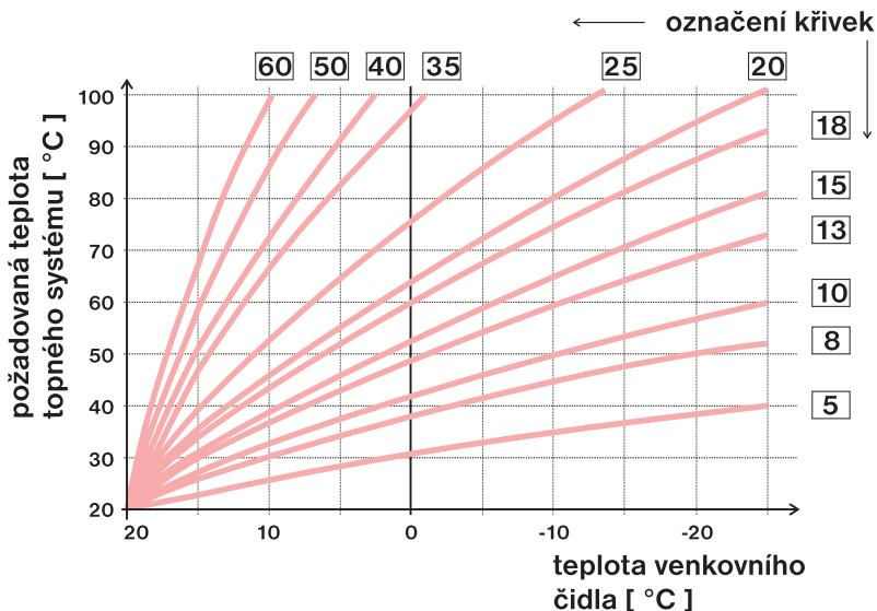
**Principem ekvitermní regulace s dorovnáním** je optimalizace teploty vody topného systému v závislosti na venkovní teplotě a na aktuální teplotě v místnosti. Tuto závislost vyjadřují uvedené ekvitermní křivky (pro požadovanou teplotu místnosti 20°C), podle kterých volíme požadovanou teplotu vody topného systému.
