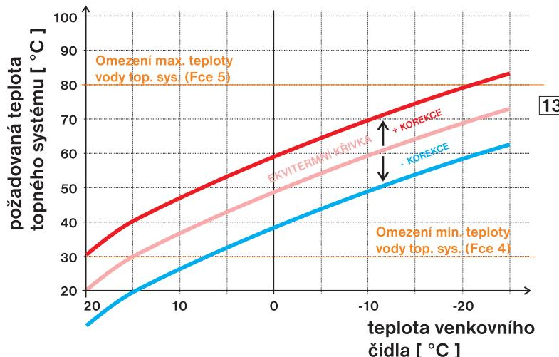
**Příklad** popisuje volbu ekvitermní křivky č.13 (růžová) a její vypočtenou korekci s koeficientem 2,5 (pro požadované teploty v místnosti 24°C a 16°C). Docílíme tak optimálního nastavení systému, kde teplota vody topného systému je regulována podle aktuální venkovní teploty.
