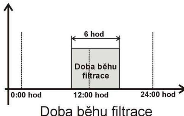
**Okamžik zapnutí filtrace** - časový střed délky běhu filtrace je určen na 14:00 hod. **Př:** pokud má být filtrace zapnuta na dobu 6 hod. Bude automaticky zapnuta v 11:00 hod a vypnuta v 17:00 hod.
