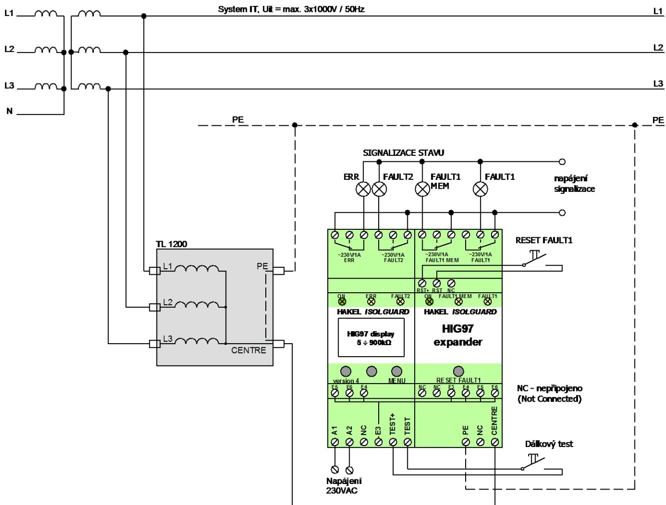
Stav kontaktů relé nakreslený na modulech ukazuje stav signalačních relé *ERR*, *FAULT1* a *FAULT2* bez napájení hlídáče. Takto jsou signalizovány stavy
