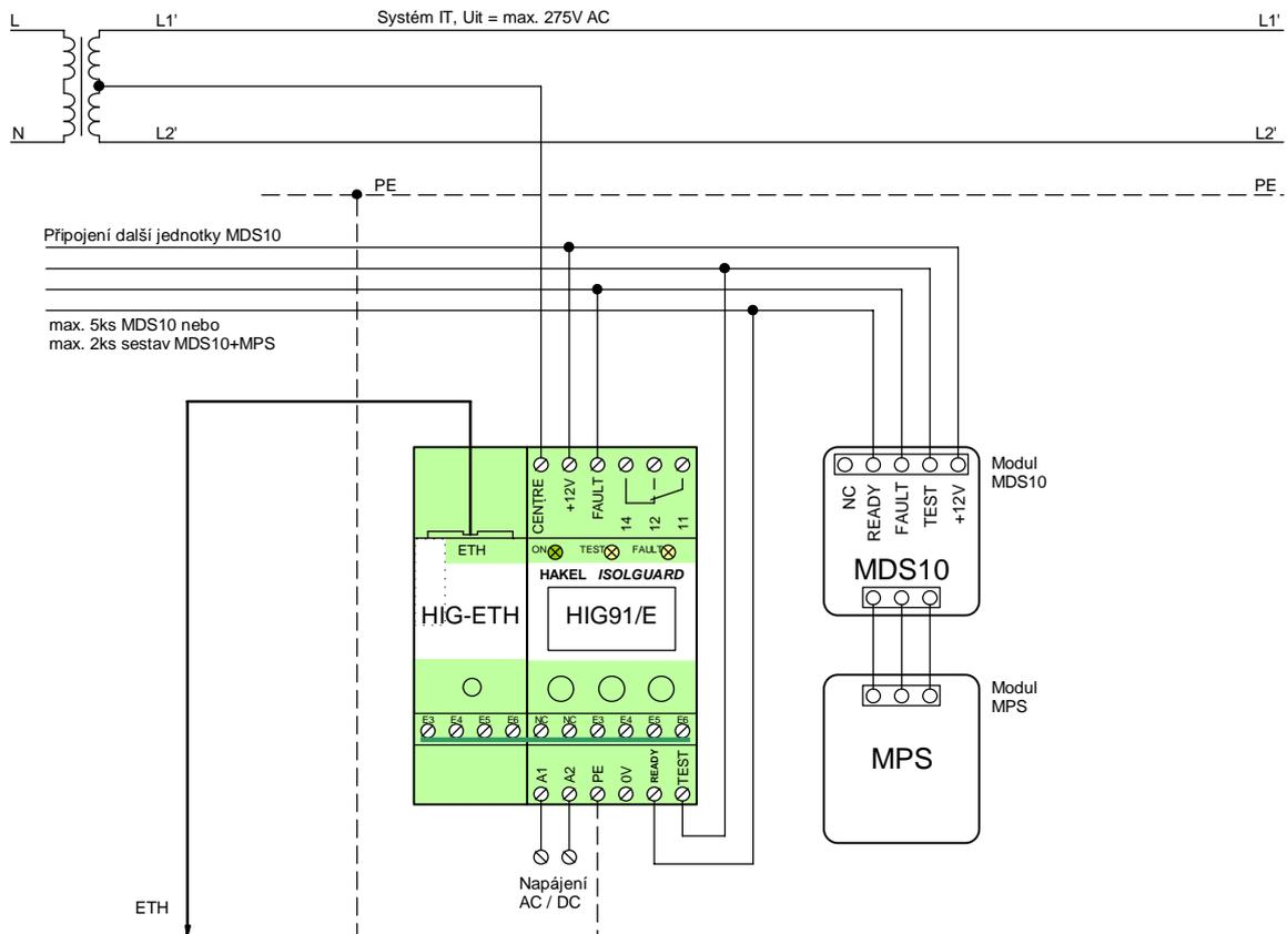
**1fázová IT soustava (max. 275 V AC), hlídač HIG91/E nebo HIG92/E v zapojení s modulem TOM (Temperature & Overload Module) a dálkovou signalizací MDS10T s modulem MPS**
