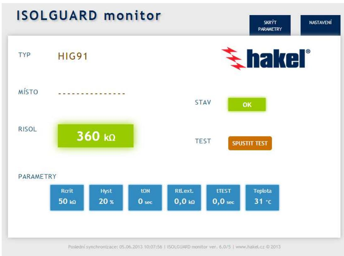
Na základní webové stránce mohou být zobrazeny údaje aktuální měřené hodnoty izolačního odporu, stav hlídače a nastavené parametry. Je dostupné tlačítko pro dálkový test hlídače. Konkrétní zobrazení u jednotlivých hlídačů může být odlišné, podle toho, jak bylo určeno zobrazení na hlavní stránce uživatelem s oprávněním „**admin**“. Na uvedeném obrázku jsou zobrazeny všechny dostupné informace.
