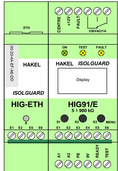
Moduly nesmí být propojeny v opačném uspořádání. Propojovací lišta se do modulů vkládá tak, aby popis „ETH“ byl na straně modulu HIG-ETH a popis „HIG“ na straně modulu HIG9x.
