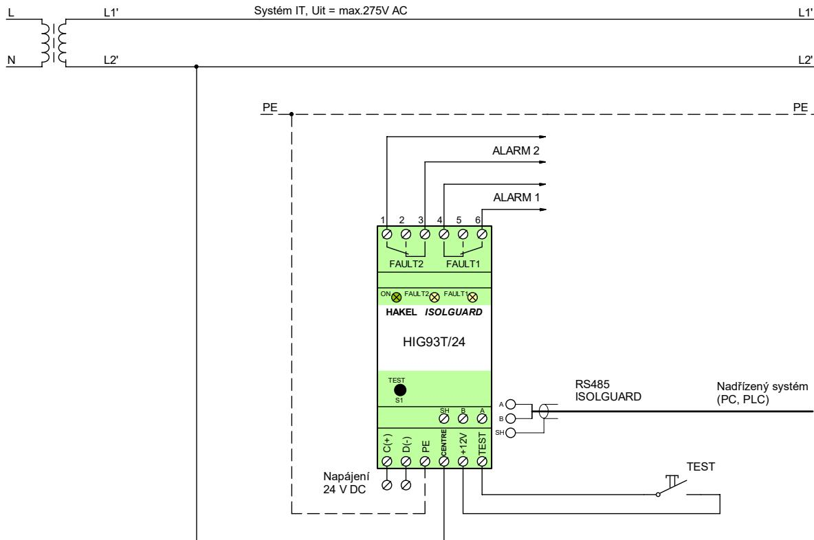
**3fázová IT soustava (3x500 V AC), modul HIG93T/24 (HIG93T/24L) se signalizací alarmu a dálkovým testovacím tlačítkem**
